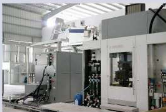
HỆ THỐNG MÁY THỐI CHAI NHỰA (Công suất 24.000 chai/giờ) Plastic bottle manufacturing system (Capacity 24.000 bottles per hour)
